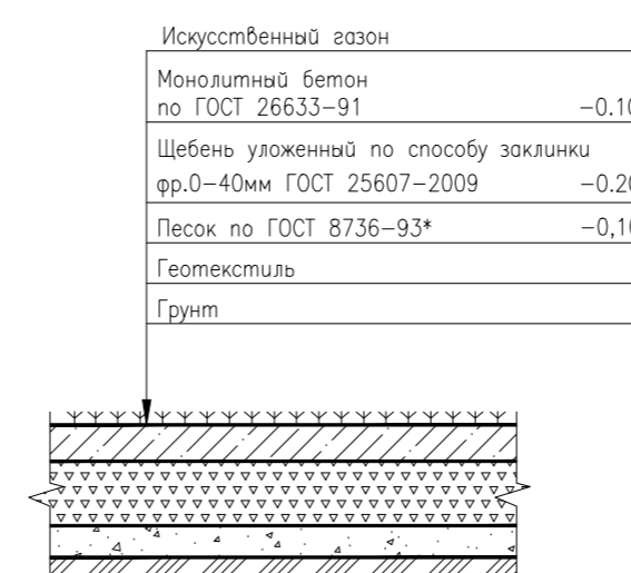
Конструкция покрытия детской игровой площадки
